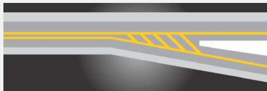
Raya Canalizadora (M-5)
